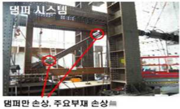
< 그림 1-10 > 댐퍼 시스템
